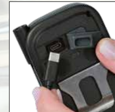
Aufladung über USB Typ A Ladekabel mit USB Typ C Anschluss
