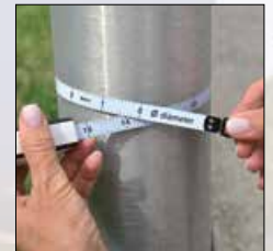
Zusatzfunktion Durchmesser- messung in Anwendung
